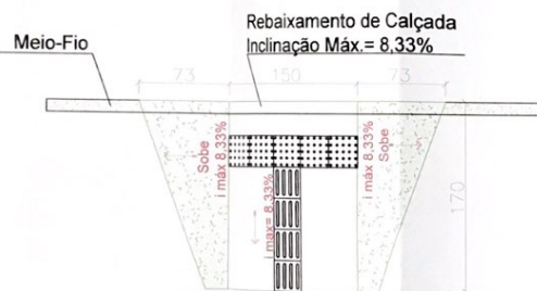
DETALHAMENTO DE REBAIXAMENTO DE CALÇADA SEM ESCALA
